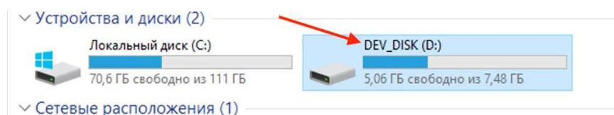
16. После подготовки флэш-дисков необходимо вставить первую флэшку (с образом для установки ОС Astra Linux 1.6) в один из USB портов аппаратной платформы и выбрать его в качестве загрузочного.
